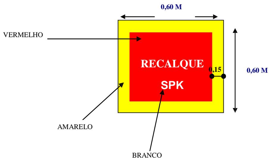
**OBSERVAÇÃO: O REGISTRO DE RECALQUE DO SISTEMA DE HIDRANTES DEVERÁ SER SINALIZADO DA MESMA FORMA ACIMA, PORÉM SUBSTITUINDO-SE AS LETRAS “SPK” POR “HID”.**
